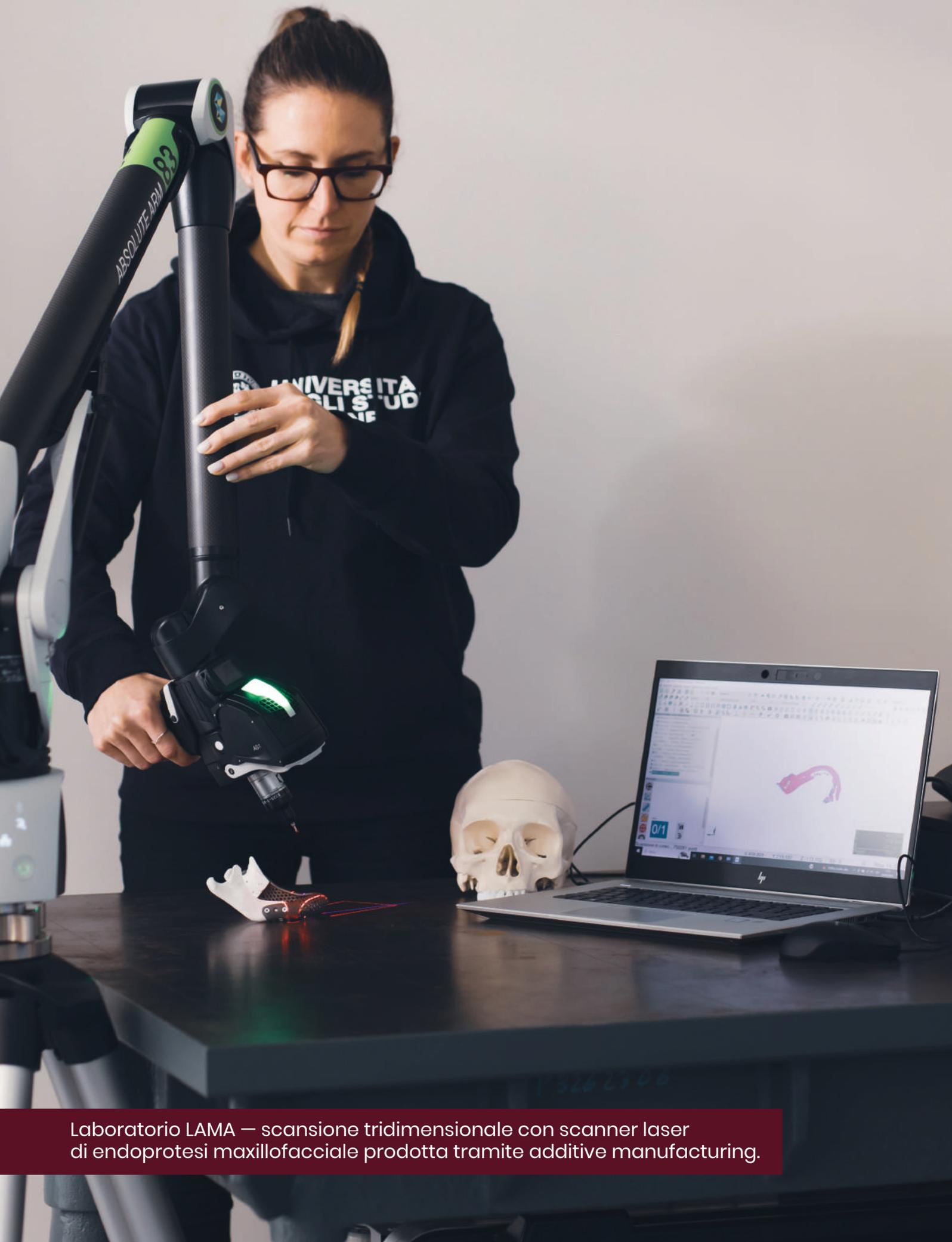
Laboratorio LAMA — scansione tridimensionale con scanner laser di endoprotesi maxillofaciale prodotta tramite additive manufacturing.
