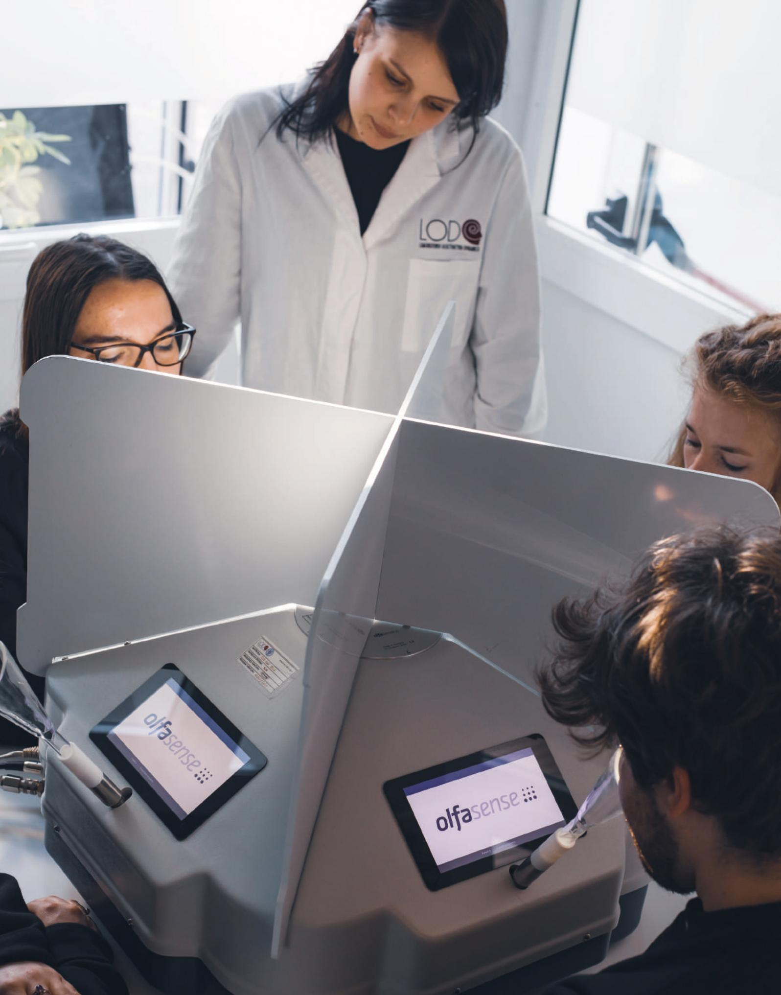
LOD LAB — odorizzazione del campione di gas combustibile secondo uni 7133-3:2023 in camera rinoanalitica.
