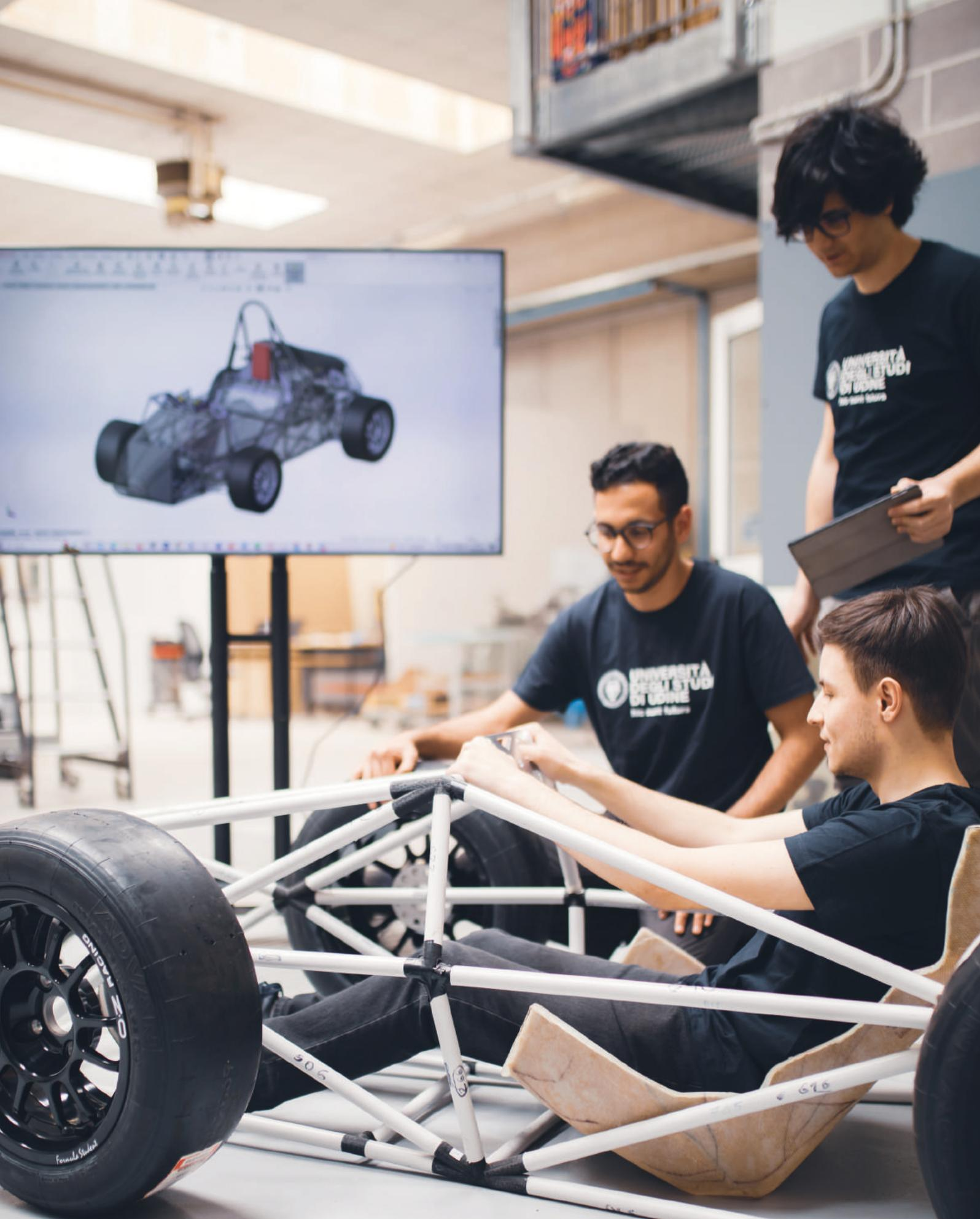
LABORATORIO TURBOMACHINERY AND ENERGY SYSTEMS LAB — progetto e-racing per la costruzione di un prototipo di macchina elettrica per partecipare al campionato formula student, parte del team al lavoro per verificare l'ergonomia dell'abitacolo.
